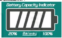
★ 上电后根据电池剩余容量显示不同颜色和数量的 LED 灯, 如图所示:
